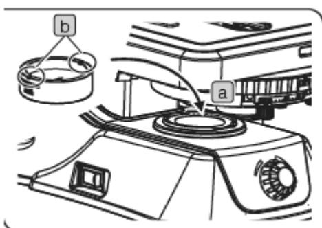
**1** 将起偏镜装入显微镜机架底部的滤色片架里 (窗式镜 **a**)，使指针 (凹面) **b** 朝上。
